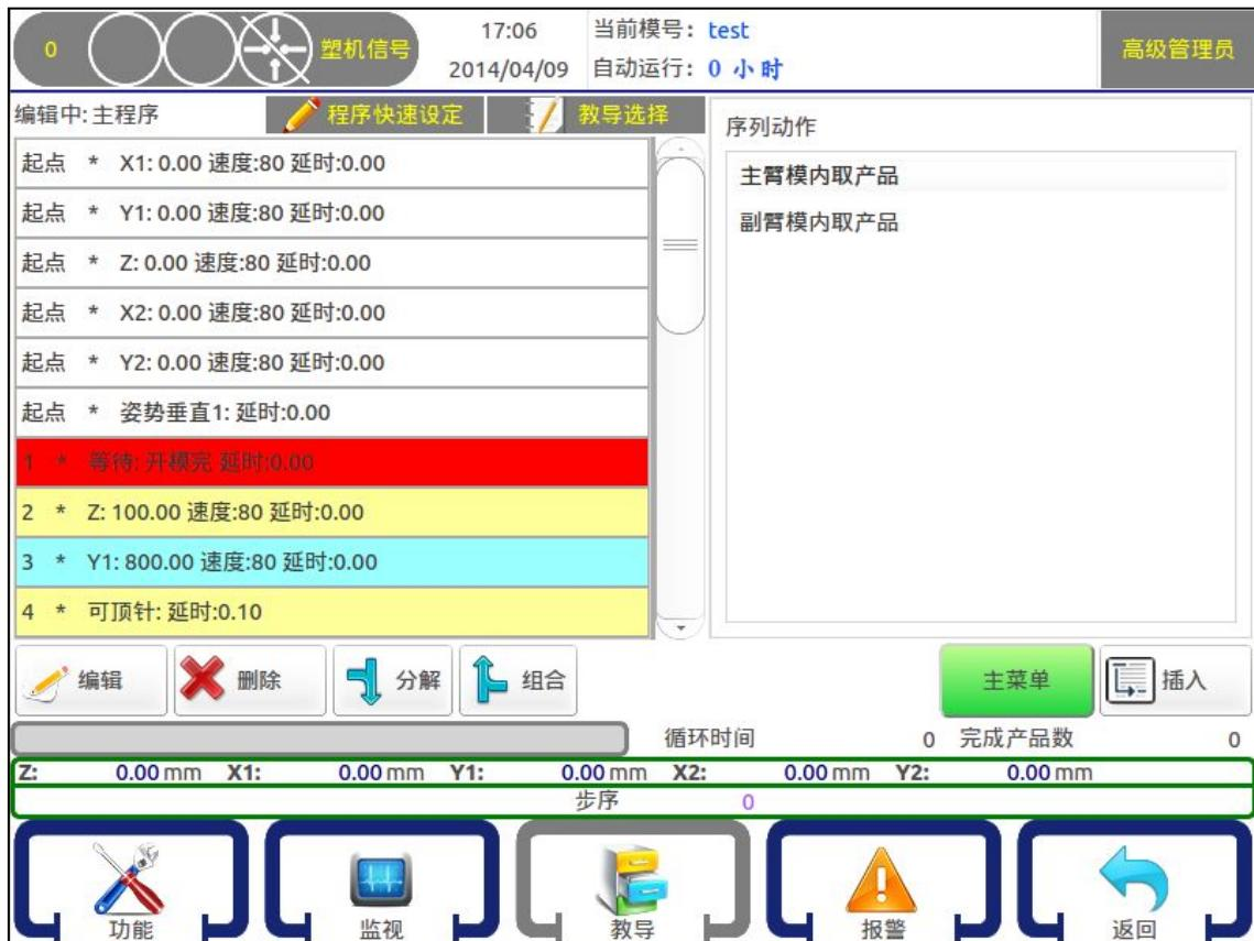
序列动作包含【主臂模内取产品】和【副臂模内取产品】两组动作，选择其中一组，选中页面左边的程序步，点击【插入】可将该序列动作教导进选择程序步的前面。
