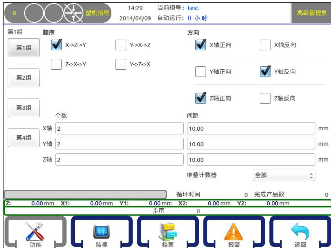
点击将要使用的堆叠程序组（如第1组），在顺序栏选择产品要堆叠的顺序，设定好每个轴的堆叠产品个数和产品堆叠间距。
