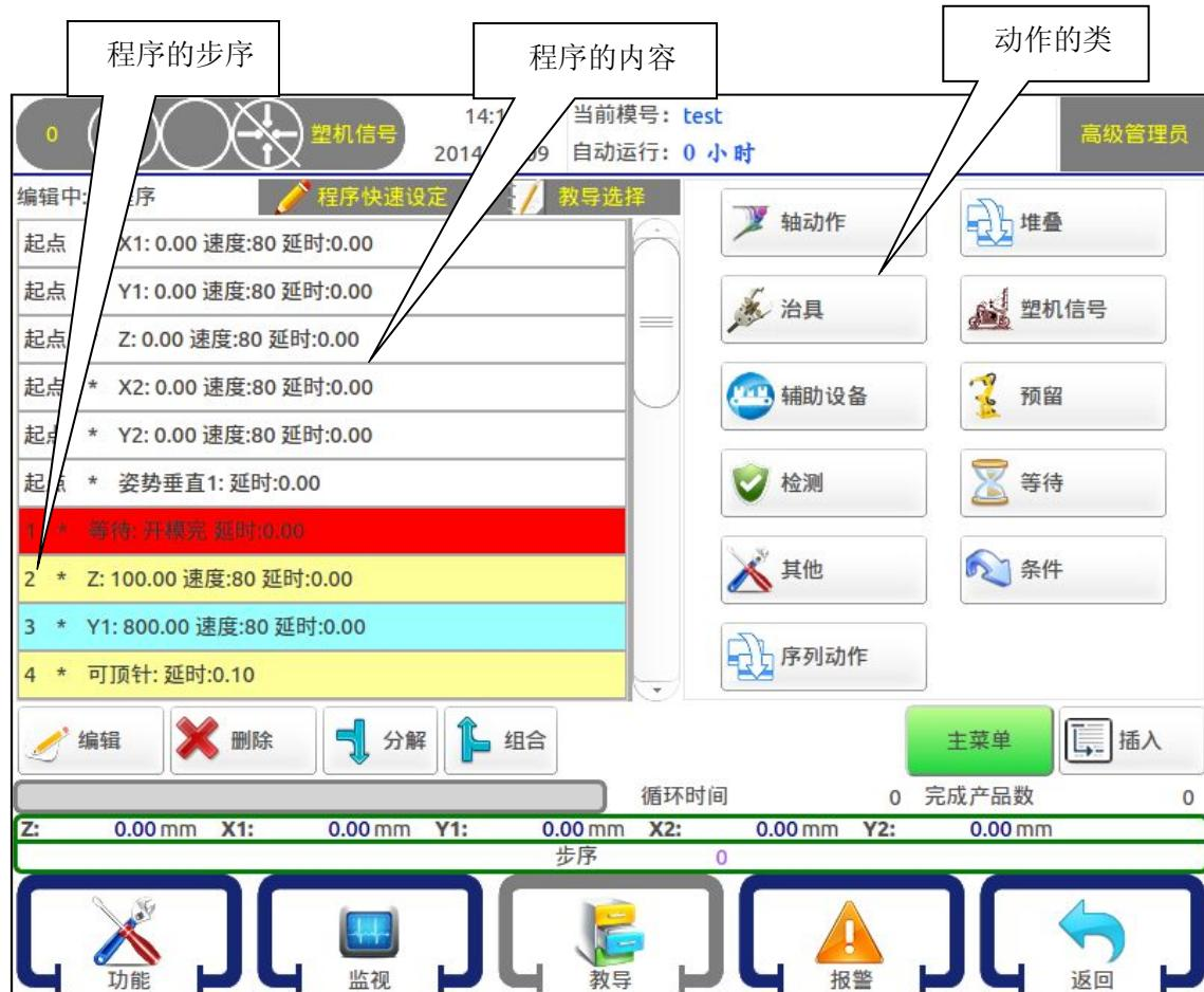
动作菜单将程序的编辑分为“轴动作”、“堆叠”、“治具”、“注塑机信号”、“辅助设备”、“预留”、“检测”、“等待”、“序列动作”、“条件”十类。点击相应的按钮即可进入该类动作的教导页面，点击【主菜单】按钮返回至教导动作的主画面。
