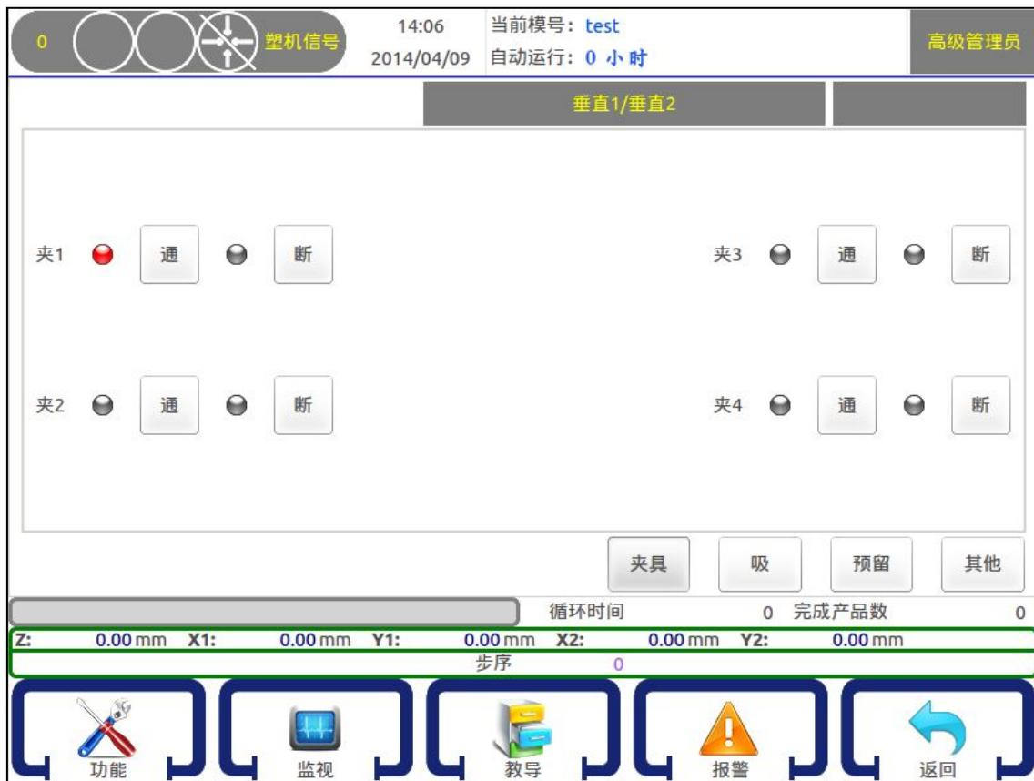
夹具有四组，点击按钮【通】即相应的夹具动作，点击按钮【断】即相应的夹具断开动作。
