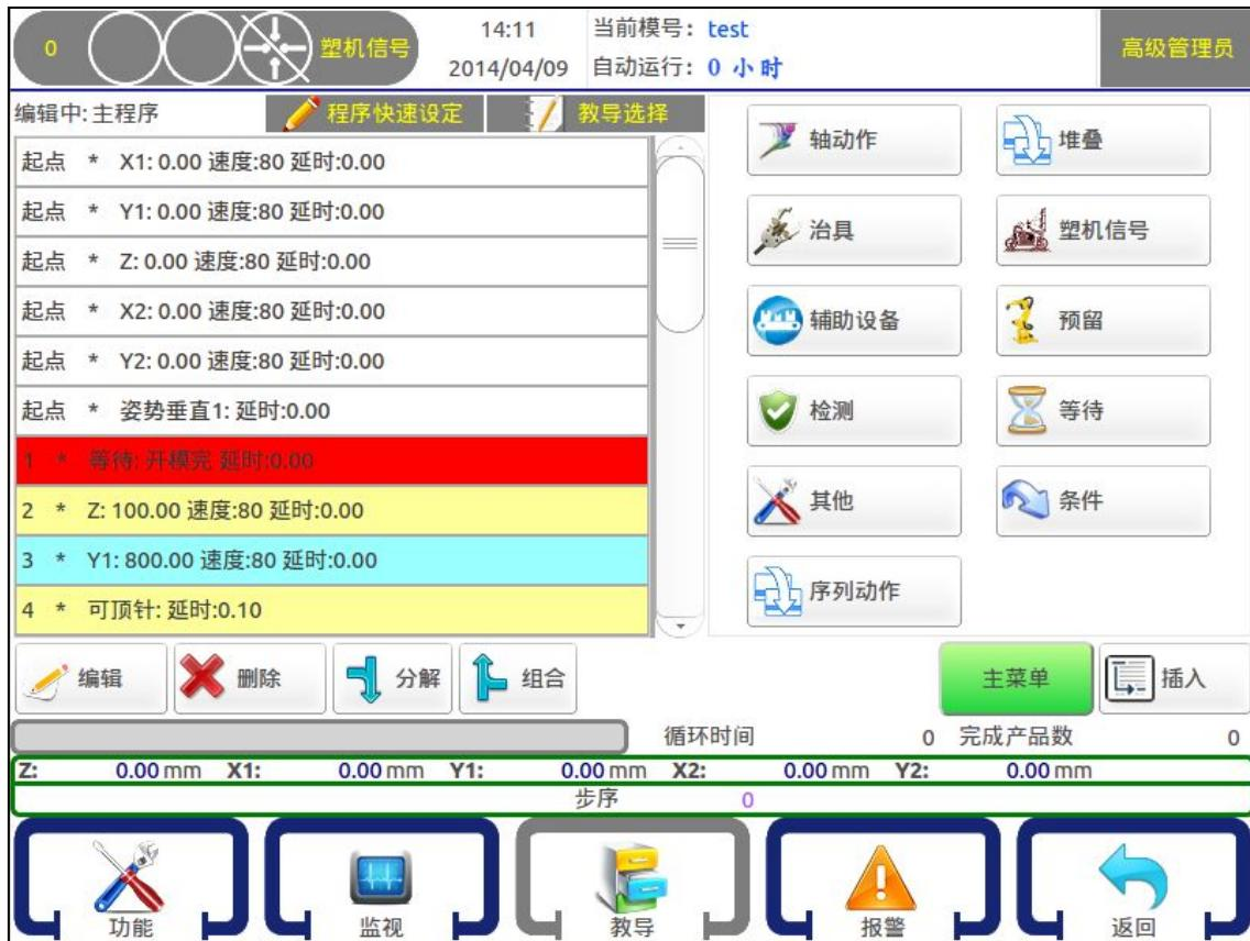
上图所示程序六步“起点”程序步为六个轴的起始位置和状态，新建一个程序已默认包含此六步程序起始点，每一个自动程序必须包含此六步步序，不可对其进行删除，只可以进行修改，点击所要修改位置再点击【编辑】键即可修改各轴的起始位置、动作速度和延时时间。
