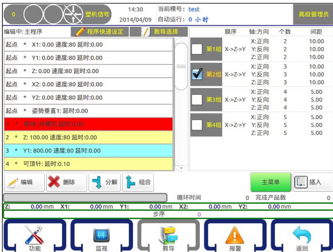
选中要插入的堆叠程序组左边的方框，如选择第 2 组堆叠程序，再点击 按钮将该组堆叠程序插入到要开始堆叠的程序步前，自动运行时，机械手即按照此堆叠程序堆叠排放产品。如果要使用 Y 轴进行堆叠时，务必将堆叠程序插入到 Y 轴下降动作之前一步。
