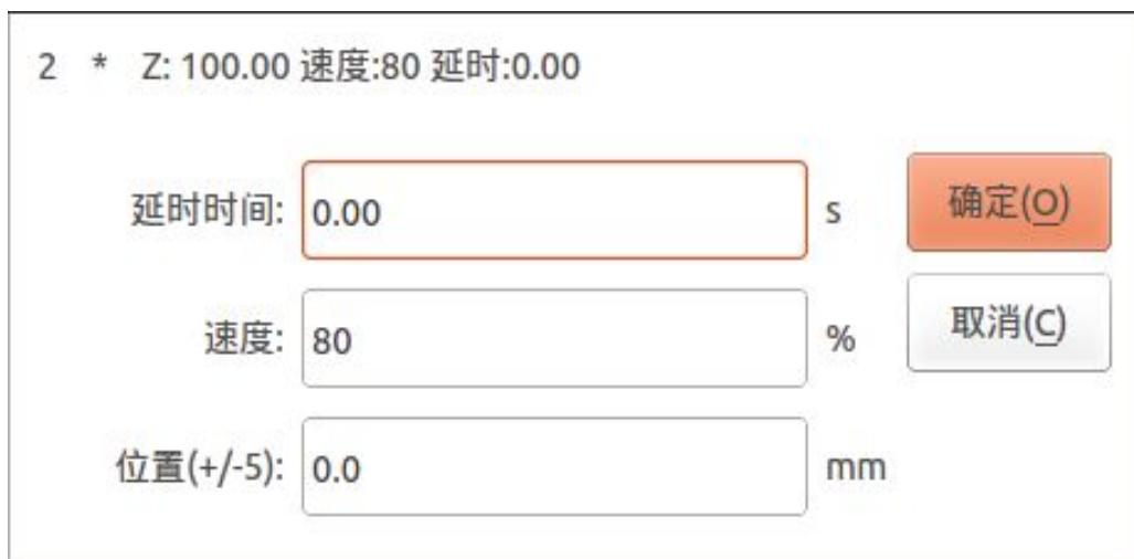
在该对话框可修改该动作的延时时间、电动轴的速度和位置，更改参数后再点击【确定】键，参数会被在线接受，从下个循环开始会按更改后的参数运行，若要取消该动作可按【取消】键。
