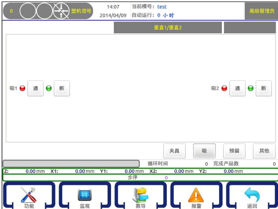
吸盘有两组，点击按钮【通】即相应的吸盘动作，点击按钮【断】即相应的吸盘断开动作。
