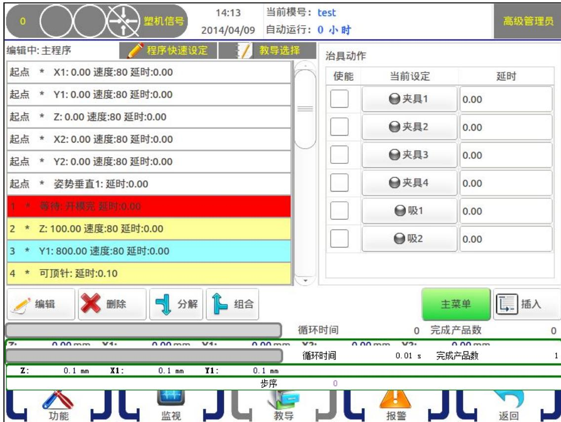
控制器可控制有四组夹具和两组吸盘动作，点击所要控制的夹具或吸盘按钮，该夹具或吸盘即输出同时按钮上的指示灯即变成红色。再点击左边的使其变成，再点击【插入】按钮将该动作插入到所选择程序步的前面。
