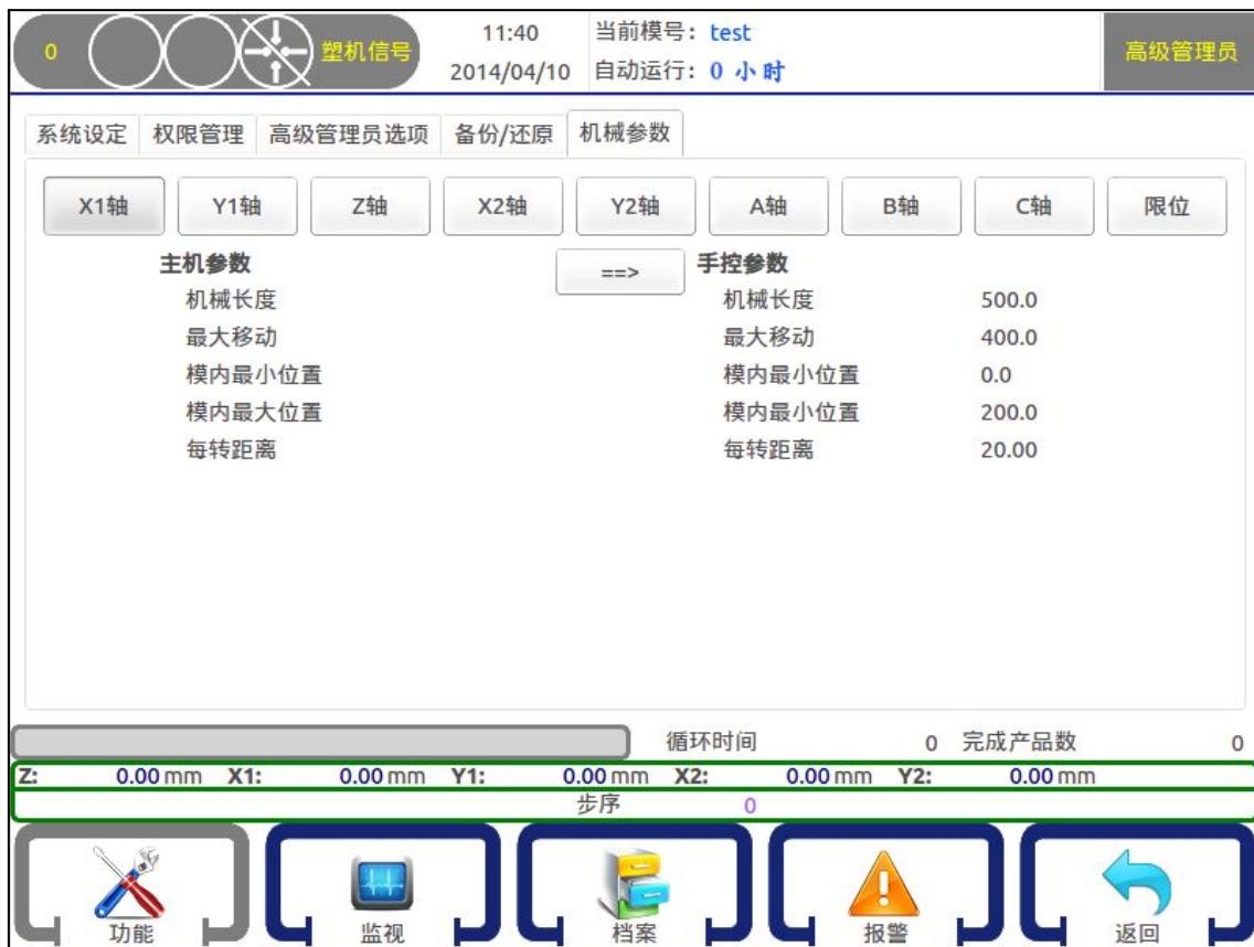
在该页面下可以查看各轴的主机参数和手控参数及限位开关信号，可以选择  将各轴的主机参数分别设入手控参数里。
