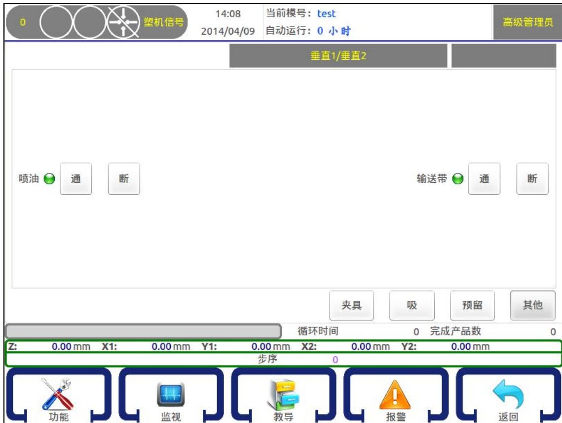
喷油、输送带等辅助设备的手动操作同吸盘的手动操作一样。
