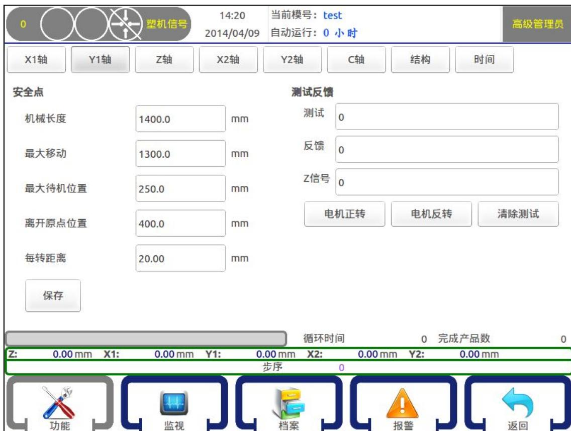
机械长度：设定各伺服轴机械结构的长度
