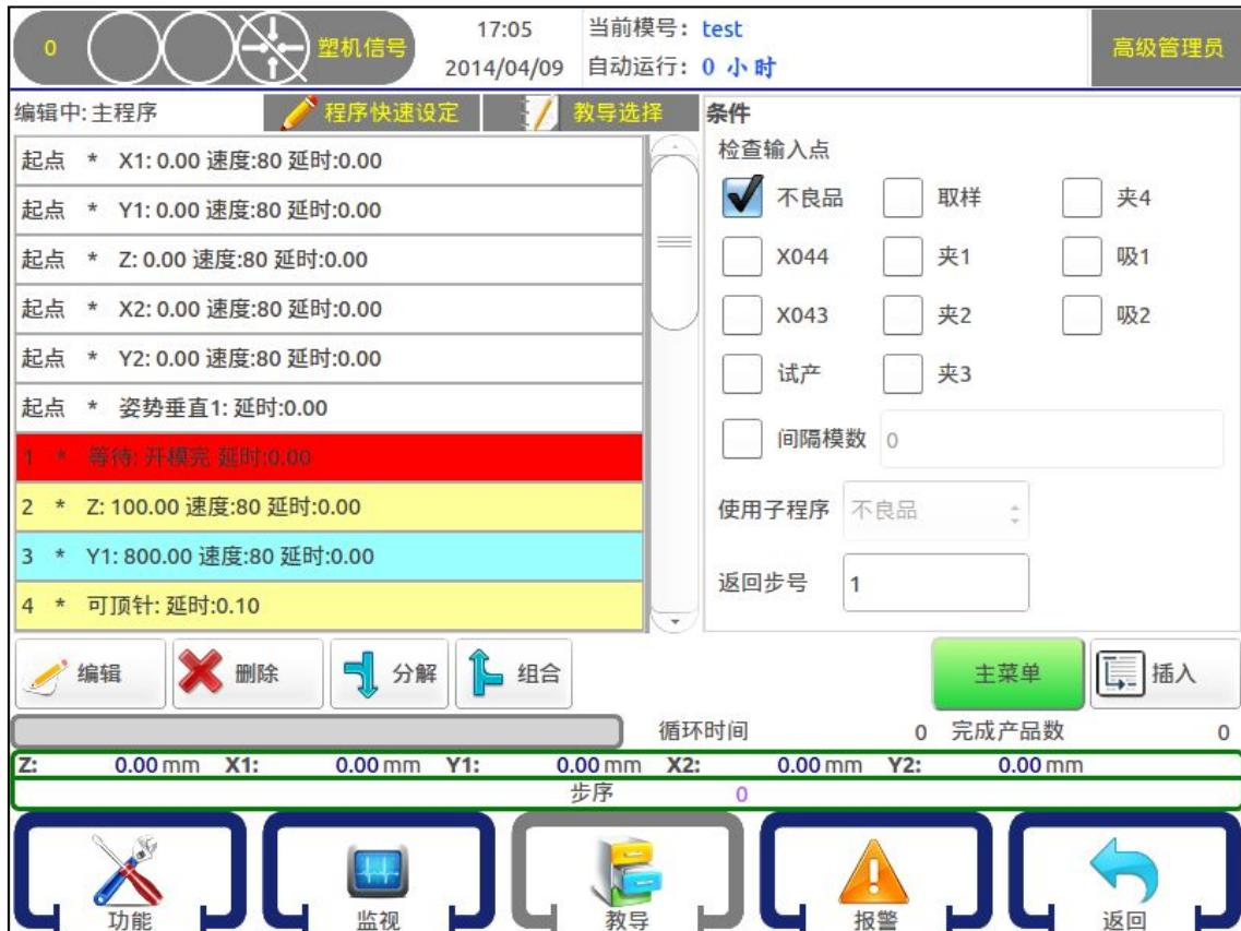
点击要检测输入点左边的  使其变成图标 ，选择使用的子程序，设定好子程序运行后返回的程序步，选中页面左边的程序步，再点击【插入】按钮即可将该检测输入点插入到所选择程序步的前面。
