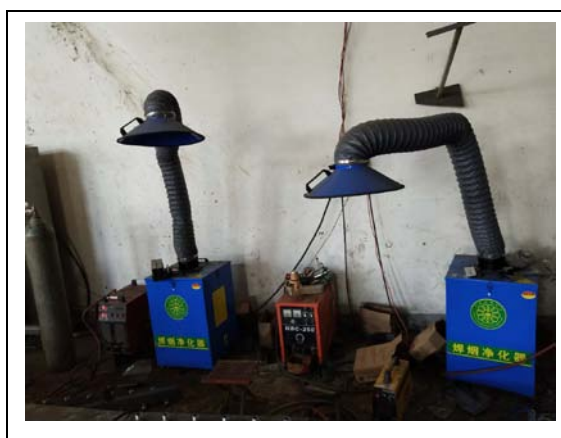
图 4-1 废气处理设备
