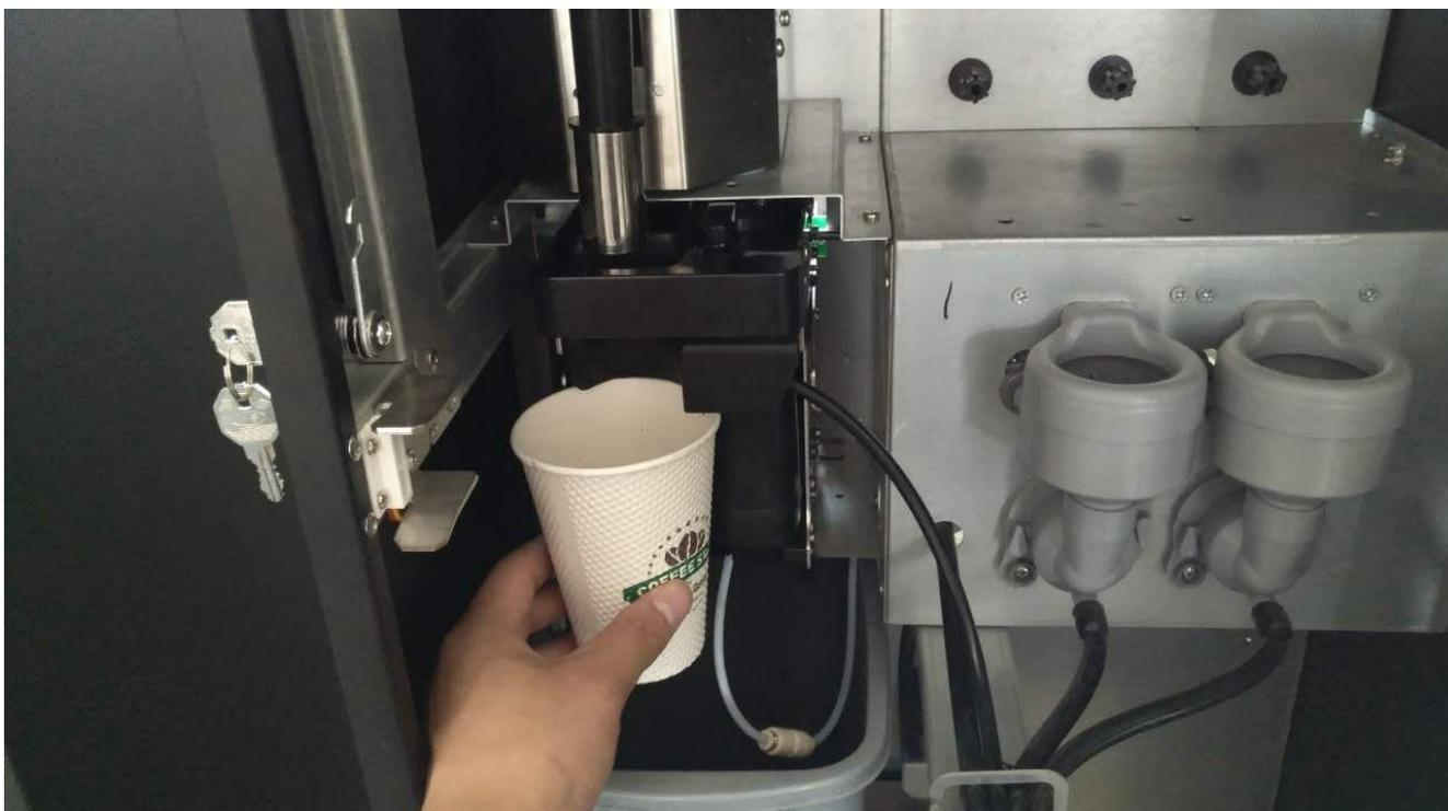
4. 研磨出来的咖啡粉过电子秤称量重量，并在校准界面输入数值
