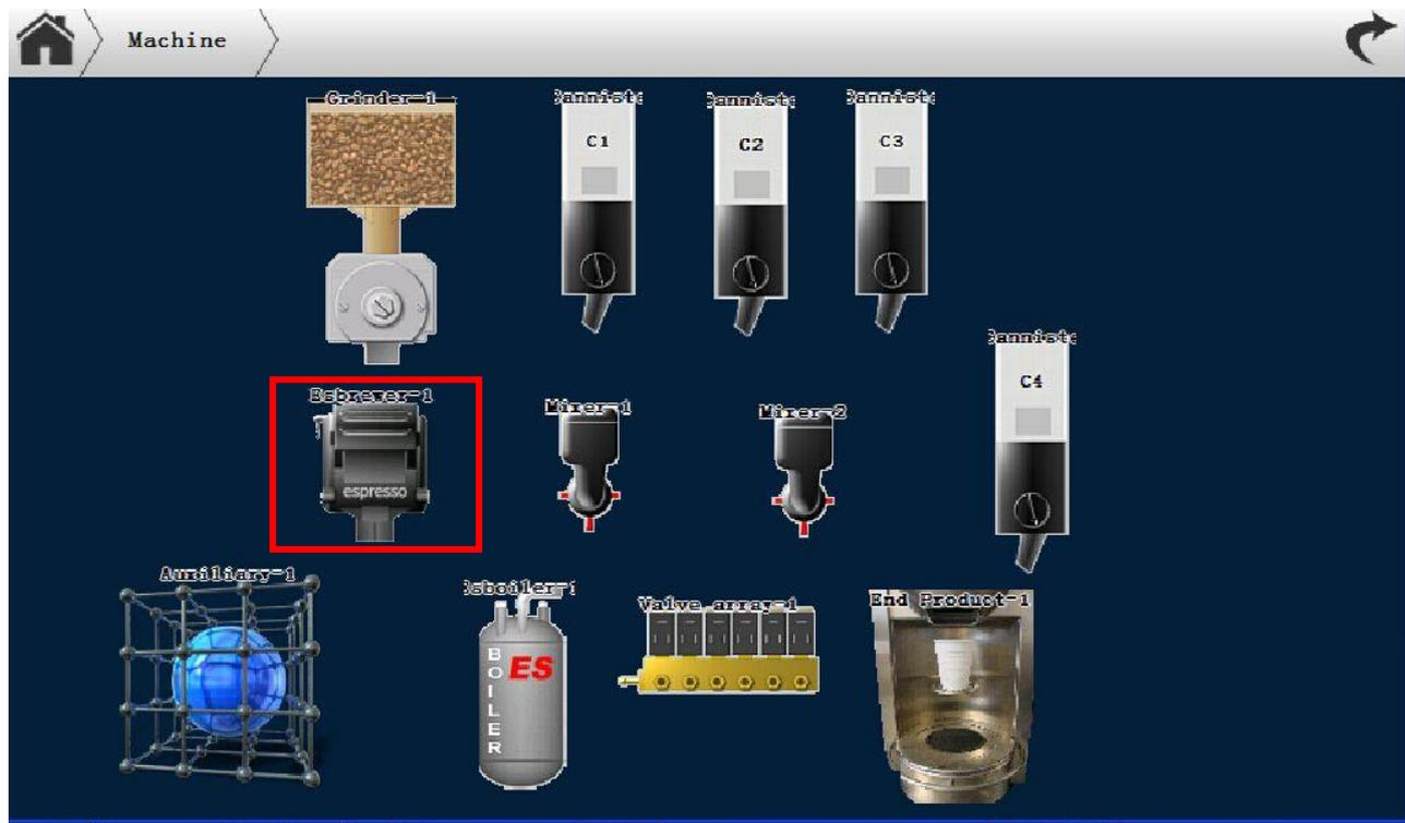
2.点击咖啡酿造器右侧的“Brewer to dosage”，酿造器的冲泡腔将自动去到接咖啡粉位置
