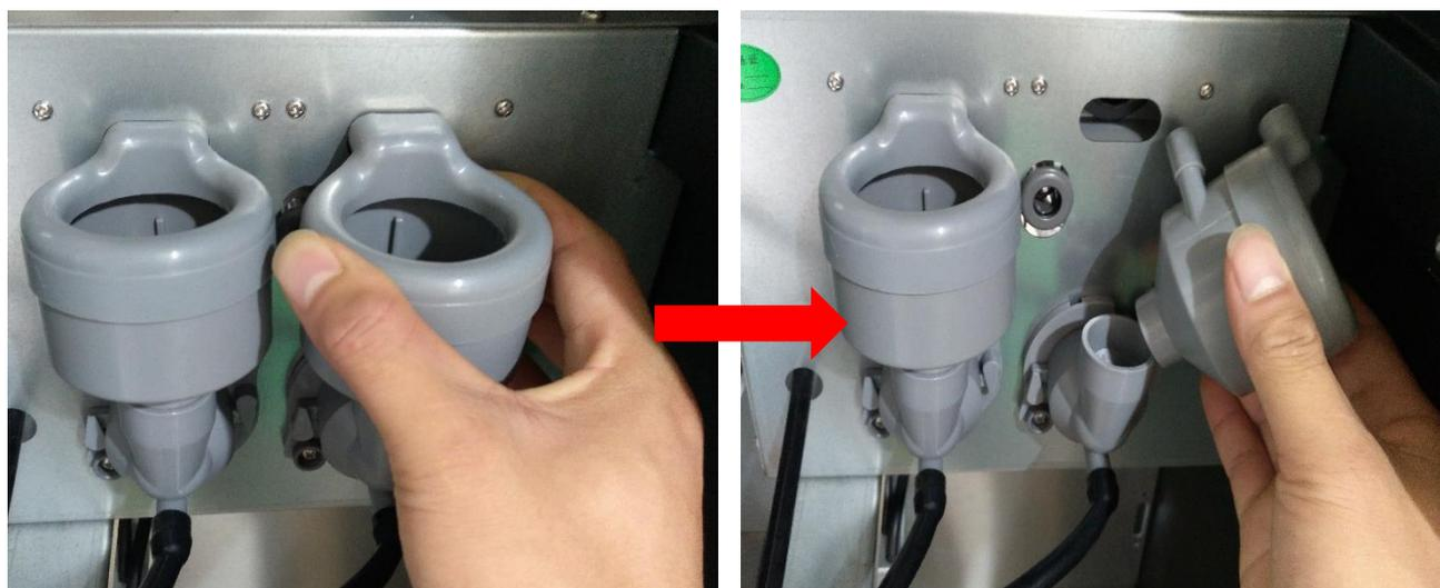
2. 将搅拌器出水口顺时针拧 90 度，拔下
