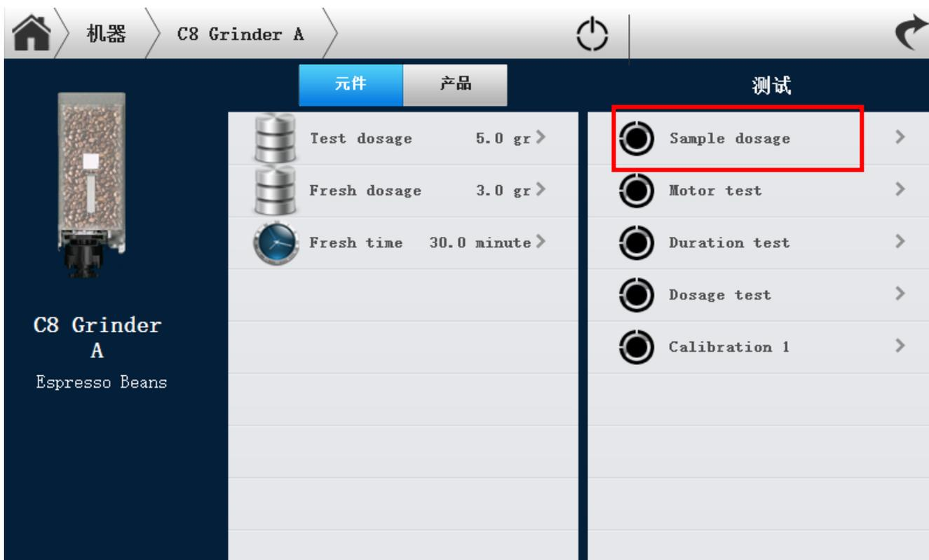
3. 点击测试栏“calibration 1” 开始校准咖啡粉，并用杯子接住研磨出来的咖啡粉
