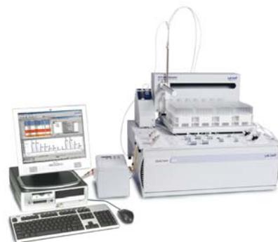
HACH 公司生产的 Quickchem 8500 (简称 QC8500) 型流动注射 (FIA) 分析仪,采用模块化设计,根据样品的分析流程,分为以下几个单元模块:自动取样单元、自动稀释单元(备选)、蠕动泵单元、化学反应单元(含样品前处理装置)、检测器单元以及数据处理单元。由计算机软件控制自动完成每一个样品的全过程分析,包括系列标准溶液的配制、取样、前处理、化学反应、信号检测、数据报告等。QC8500 型流动注射 (FIA) 分析仪的主要特点如下:
