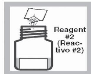
加2号粉枕试剂到反应瓶中，然后摇动使其溶解。
