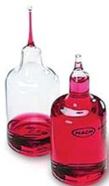
特定反应提供了准确剂量的试剂, 而且安瓿瓶可作为比色皿直接比色。
