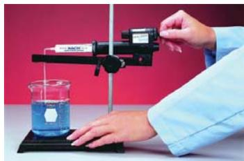
采用哈希公司提供的数字滴定器及配套的滴定剂, 可测量 20 个以上的参数。相对于传统的玻璃管滴定装置, 数字滴定器可以对消耗的滴定剂体积加以计数, 并精确至微升, 滴定终点容易掌握。数字滴定器可以在工厂和野外工作现场操作, 突破了玻璃管滴定装置只能在实验室操作的环境条件限制。
