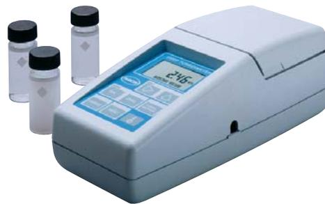
2100P 浊度仪采用便携式设计:(1) 在野外使用,电源由电池提供;(2) 坚固的手提箱既可存放仪器,又可安全运输,且携带方便。
