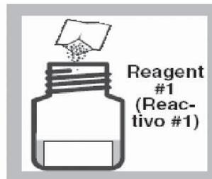
加1号粉枕试剂到反应瓶中，然后摇动使其溶解。
