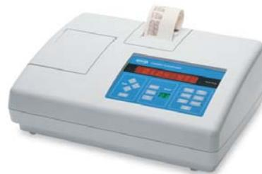
仪器具有数据存储功能，可通过 HachLink™ 软件将实验数据直接下载至计算机，便于数据的存储与管理。内置的打印机可以直接打印测量结果及相关参数。
