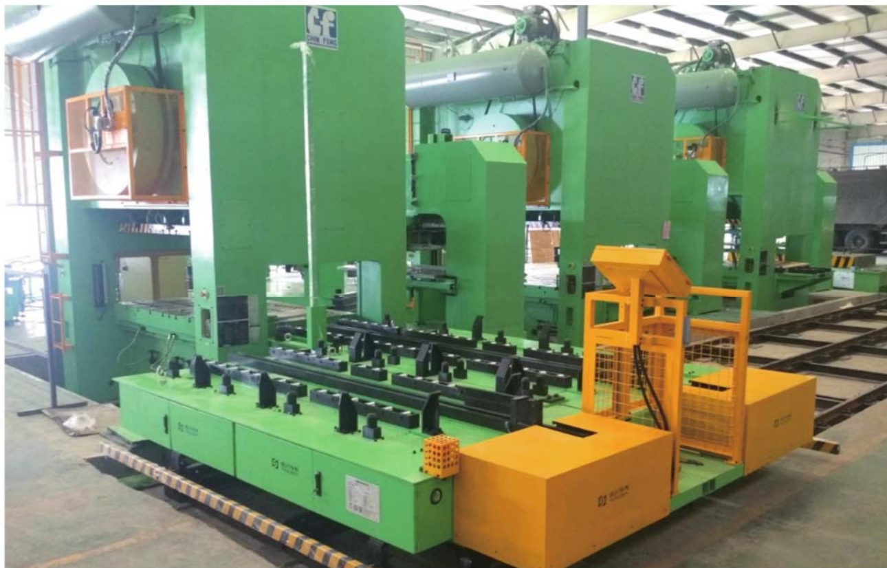
▲ 双工位三机连线侧面进模（安徽美的实拍）
