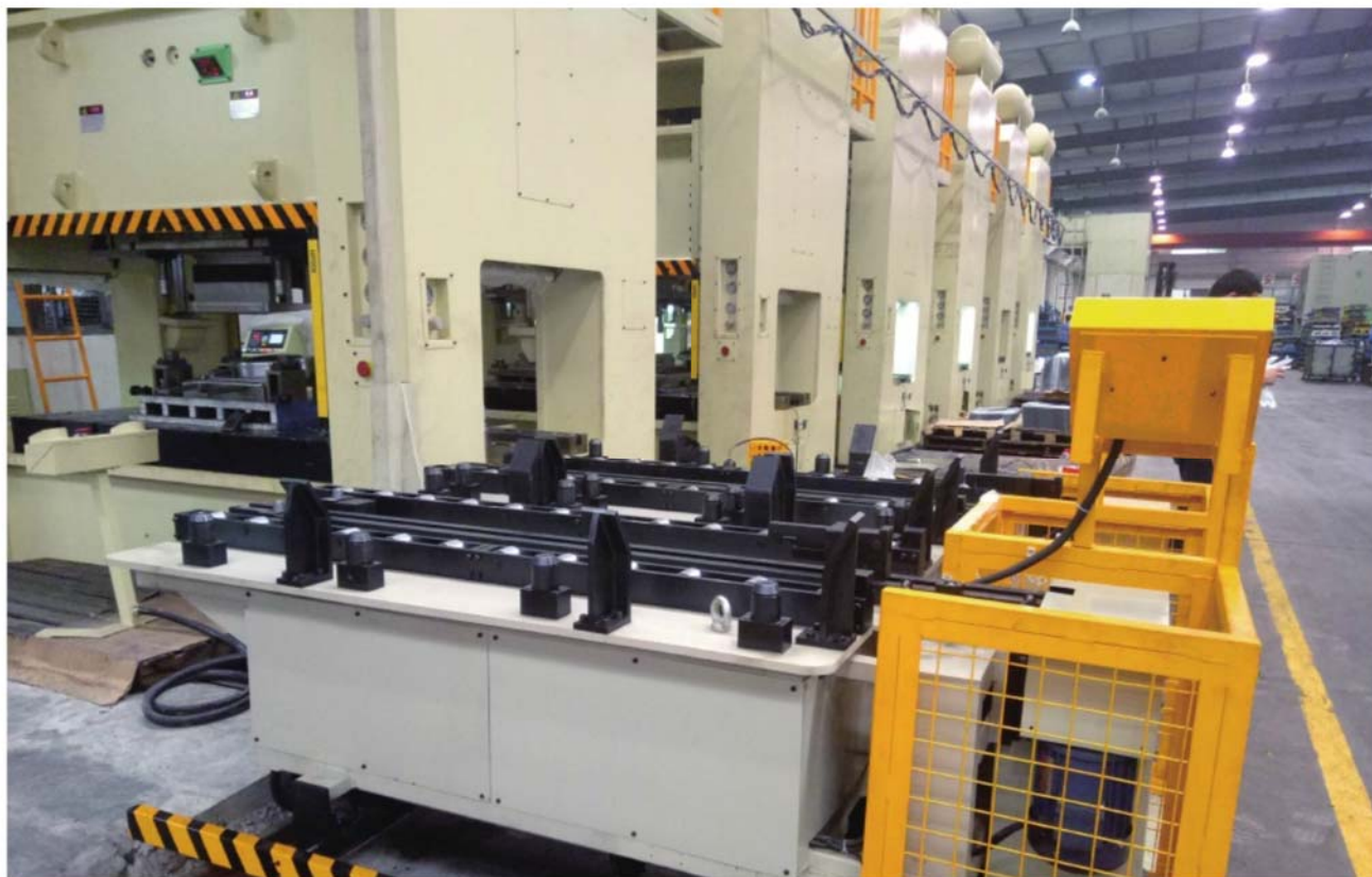
▲ 双工位六机连线侧面进模（上海云飞实拍）
