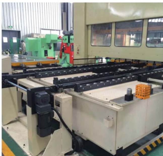
▲ 双工位前方进模（上海明芳实拍）
